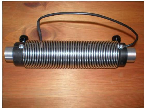
Inserire ora in testa al tubo la bobina tenendo il filo di collegamento verso il centro del dipolo
