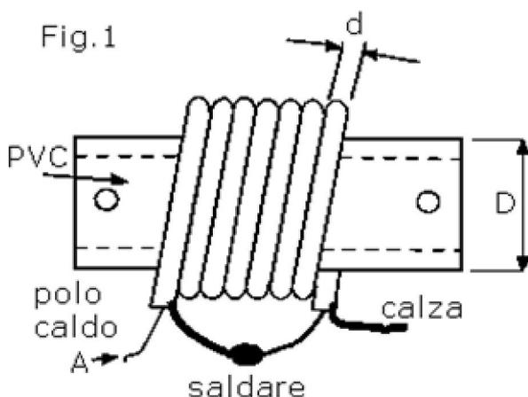
Per quel che riguarda la messa in opera della trappola in cavo coassiale, la figura 1 è senz'altro eloquente. Per avere le massime prestazioni, è buona norma fare in modo che l'avvolgimento sia il più "quadrato" possibile, e cioè che la lunghezza dell'avvolgimento sia il più possibile uguale al suo diametro.
