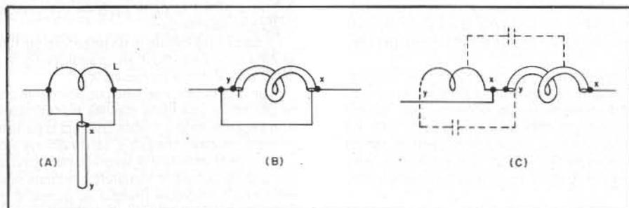
Le induttanze e capacità costituenti le "trappole" per antenne multibanda possono essere realizzate anche con degli spezzi di cavo coassiale. Una trappola del genere, oltretutto, presenta non pochi vantaggi rispetto ad una tradizionale, non fosse altro che per la relativa facilità con la quale può essere costruita.
