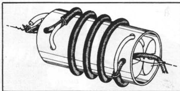
**Fig. 3 -** La calza del cavo è usata quale induttanza. L'inizio dell'avvolgimento è saldato al primo uncino di rame stagnato da 1 mm che è fissato sull'isolatore a noce; in tale punto sarà, a costruzione eseguita, fissata una delle sezioni di filo dell'antenna.
