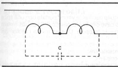
Fig. 6 - Il conduttore interno e la calza esterna di una trappola in cavo coassiale formano - alla frequenza di risonanza - praticamente un'unica bobina. Alle frequenze più basse della risonanza, la bobina funziona come una semplice induttanza di carico, ma solo la parte esterna (a destra nel disegno) è attiva e costituisce un carico induttivo ben più basso di quello che si avrebbe con altri tipi di trappole.
