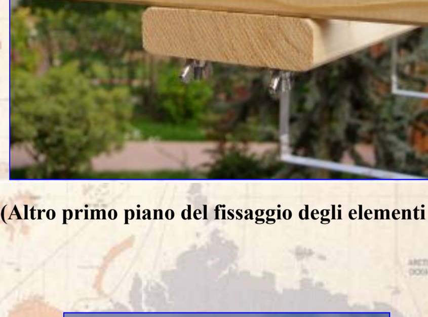
Foto 5 (Altro primo piano del fissaggio degli elementi sul boom)
