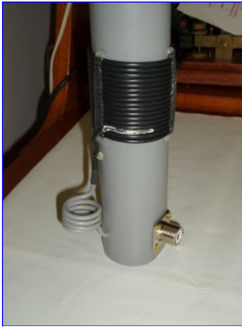
Foto 2 (Particolare dell'avvolgimento TUNING COIL)
