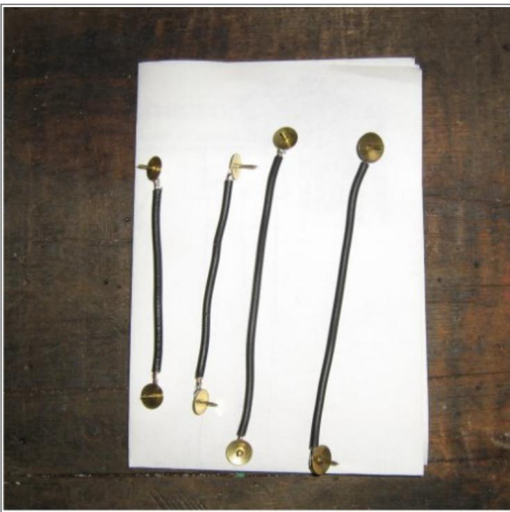
Ora passiamo alla taratura...bisogna fare 4 spezzoni di cavo, 2 da 10 cm e 2 da 5 cm, che andranno saldati su degli spilli. Io ho usato delle comuni puntine da disegno, visto che sono in ottone e quindi la saldatura è più agevole.
